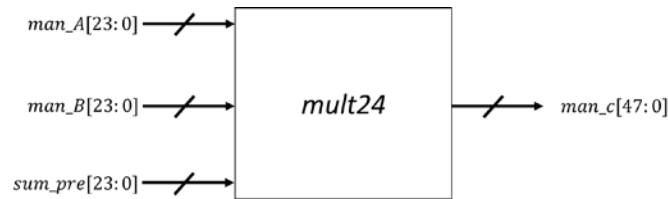
Fig. 4. Bloque correspondiente a un multiplicador de 24 bits.
