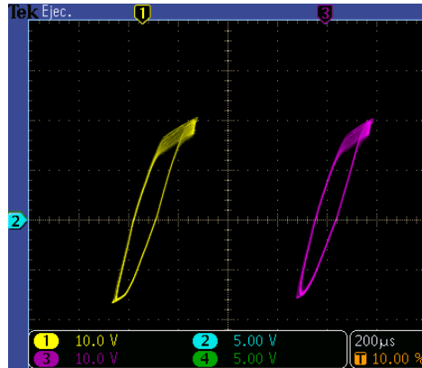
Fig. 8. Retrato de fase de los dos circuitos de Chua.
