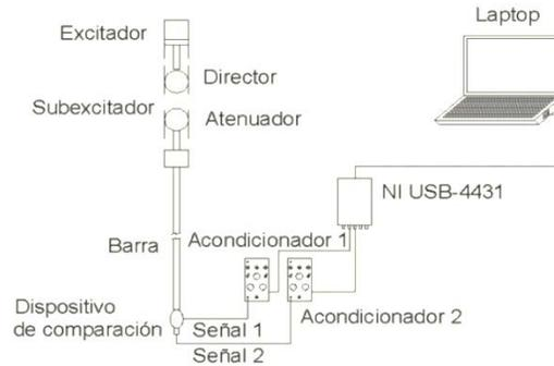
**Figura 3. Calibración secundaria mediante comparación**
