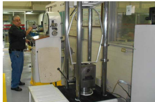
Figura 7. RPS colocado verticalmente para ensayo con carga de 2700 N.
