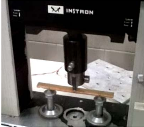
Figura 4. Probeta de fibra de vidrio colocada en posición para realizar el ensayo de flexión a 3
