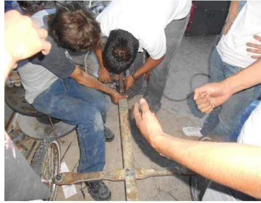
Figura 11. Ensamble de los ejes principales con las llantas y el amortiguador.
