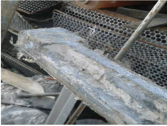
Figura 10. Eje con perfil en T, apenas desmoldado.
