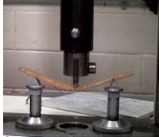
Figura 5. Punto de ruptura de la probeta de fibra de vidrio.
