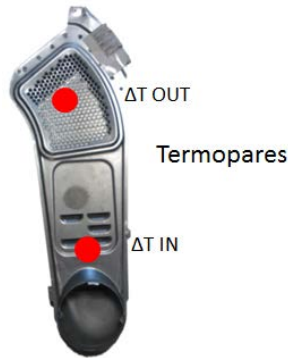
Figura 9. Instrumentación del ducto de transición.
