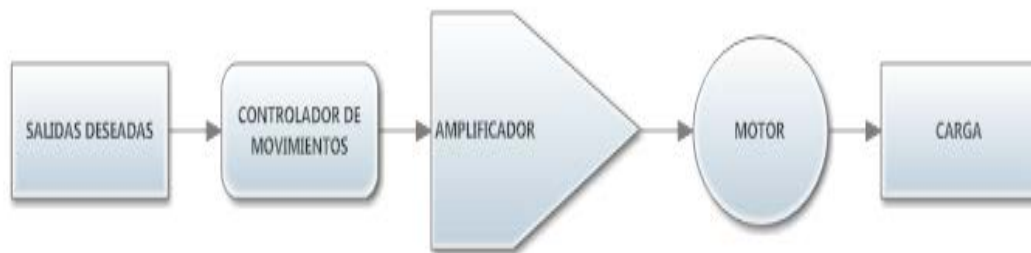
Figura 5. Diagrama de bloques para un sistema de lazo abierto.
