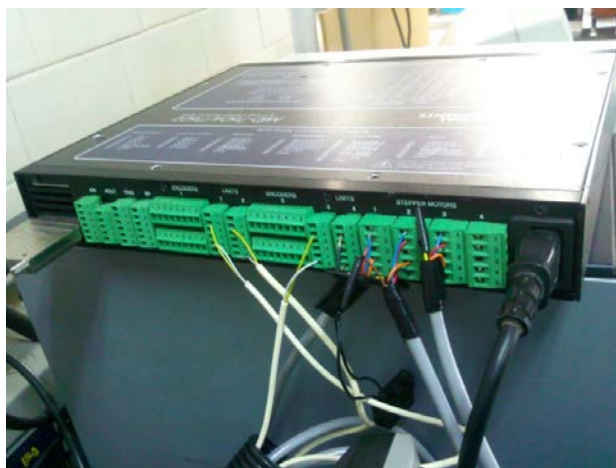
Figura 12. Conexión de los motores y los finales de carrera con el driver.
