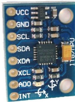
Figura 3 Configuración de la Placa del MPU-6050.
