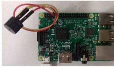
Figura 9 Implementación del sistema de terminal de alarma.
