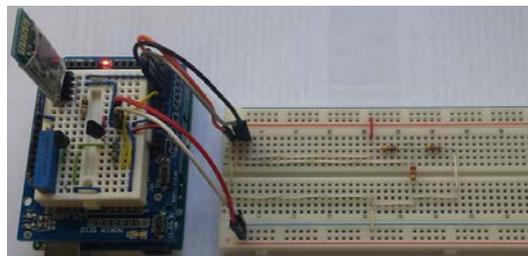
Figura 13 Voltímetro y circuito resistivo de ejemplo.
