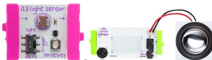
Figura 9 Módulos LittleBits: Sensor de luz y bocina.
