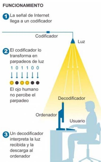
Figura 3 Estructura general de un enlace VLC.
