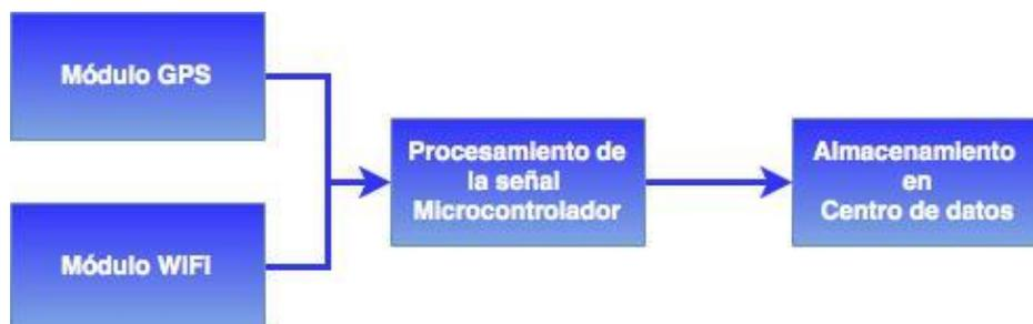
Figura 1 Diagrama a bloques del sistema de rastreo.
