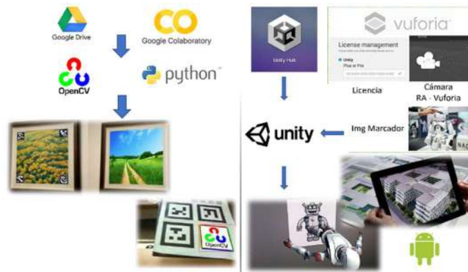
Figura 2 Diagrama del proceso para la creación del App's con RA (OpenCV vs Unity - Vuforia).
