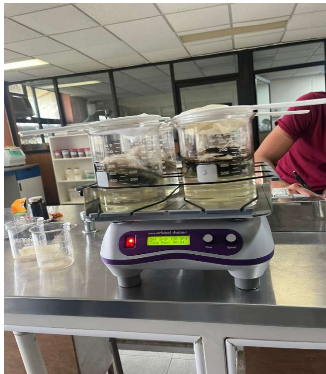
Figura 15. Muestra vasos de precipitado en la mesa giratoria previamente añadido 3 ml. de hidrocarburo. Para ser agitados durante 15 min a 150 rpm.
