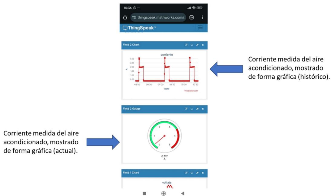
Figura 2 Corriente del aire acondicionado registrada por el sensor inalámbrico, un dispositivo móvil.
